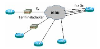
Bei Sternkonfigurationen wählen sich die Außenstellen in den Anschluß des Zentralrouters ein. Die Anzahl der gleichzeitig mit der Zentrale verbundenen Außenstellen ist somit durch die in der Zentrale zur Verfügung stehenden ISDN B-Kanäle begrenzt (2 B-Kanäle pro ISDN Basisanschluß).
